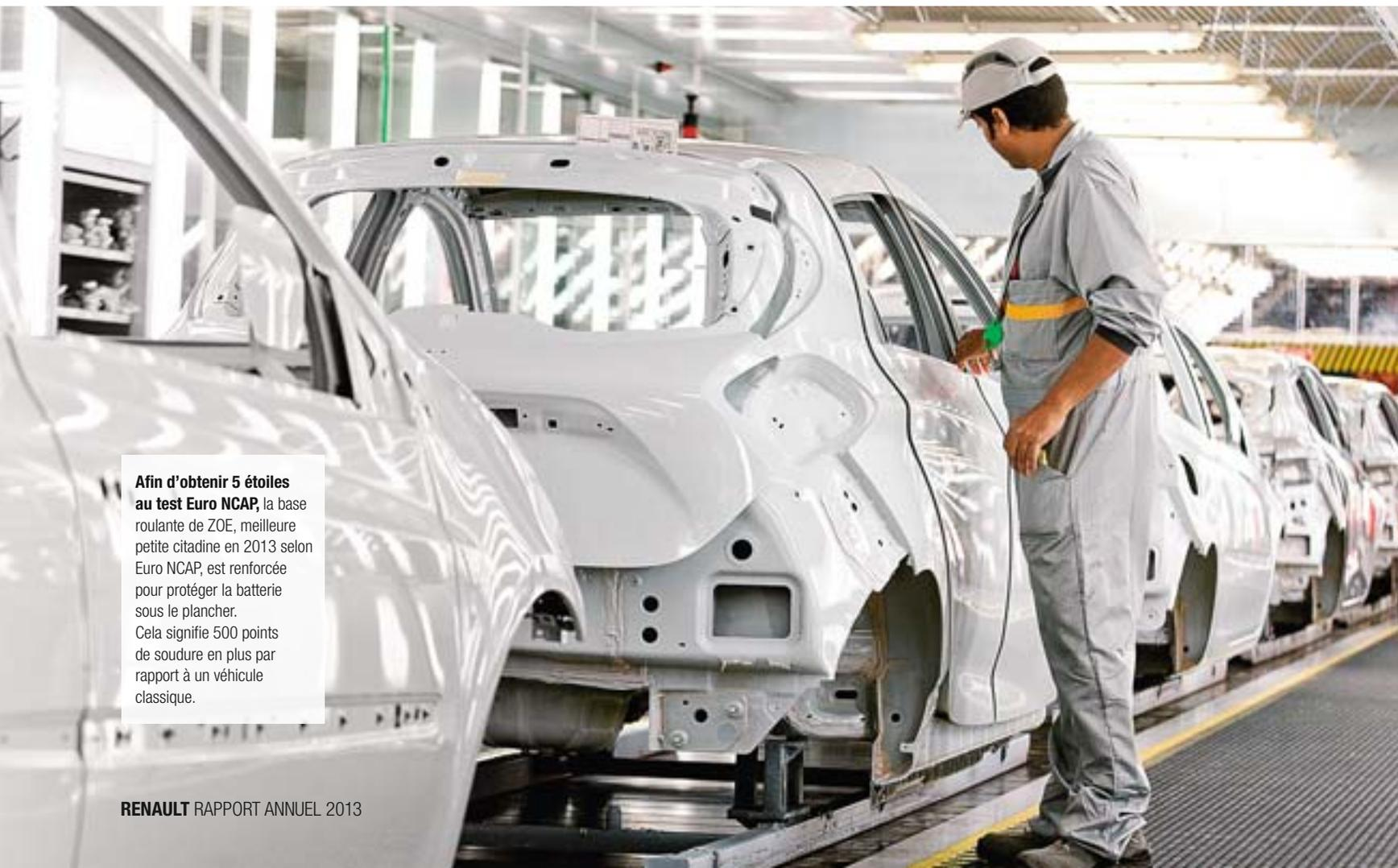
**Afin d'obtenir 5 étoiles au test Euro NCAP**, la base roulante de ZOE, meilleure petite citadine en 2013 selon Euro NCAP, est renforcée pour protéger la batterie sous le plancher. Cela signifie 500 points de soudure en plus par rapport à un véhicule classique.
